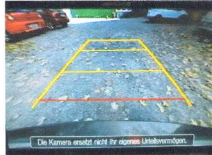
nur Einblendung des Kamerabildes mit statischen Hilfslinien only camera image with fixed lines (lanes don't move)
